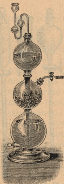
Rys. 70. Aparat Kipp'a do wydobywania gazów na zimno.
