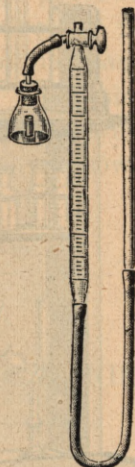
Rys. 85. Aparat Lungego do oznaczania azotu w moczu bez statywu.
