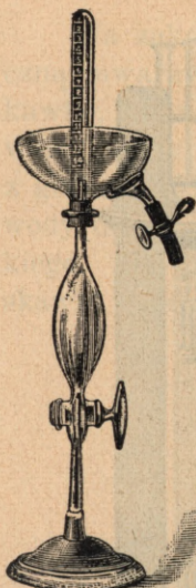
Rys. 83. Aparat Hüffner'a do azotu w moczu.
