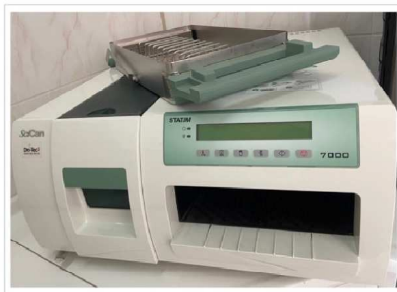
Figura 10. Autoklaw kasetowy Statim 7000 (WĆ)
