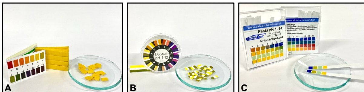
Rys. 9.1. Papierki wskaźnikowe: A – uniwersalne w wersji klasycznej (książeczka do odrywania i cięcia), B – typ „Duotest” z dwoma polami barwnymi, C – paski typu „pH-fix” z czterema polami barwnymi.
