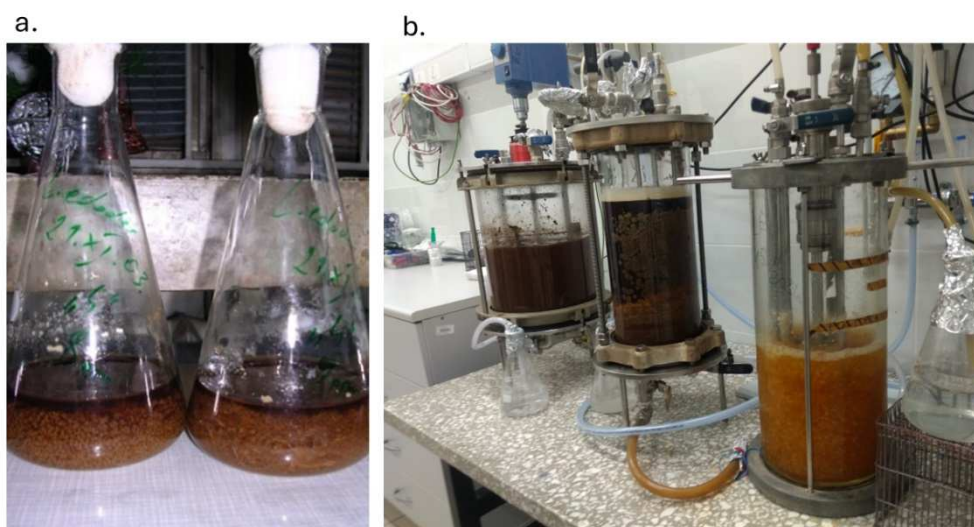
Ryc. 5. Hodowle wgłębne mycelium grzybów wyższych w podłożach płynnych w skali a.) 200 ml, hodowla wstrząsana, b.) w skali 4-7 litrów, hodowle w bioreaktorach o różnej pojemności roboczej i systemach mieszania
