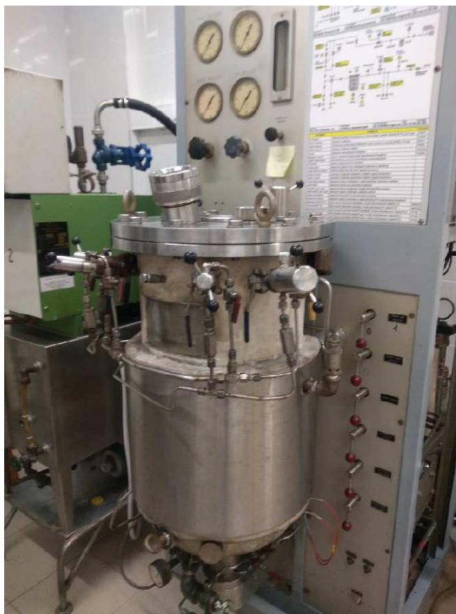
Ryc. 10. Bioreaktor firmy New Brunswick do prowadzenia procesów okresowych w skali ćwierćtechnicznej, o pojemności całkowitej 70 l (pracownia biotechnologii farmaceutycznej Katedry i Zakładu Technologii Leków i Biotechnologii Farmaceutycznej)
