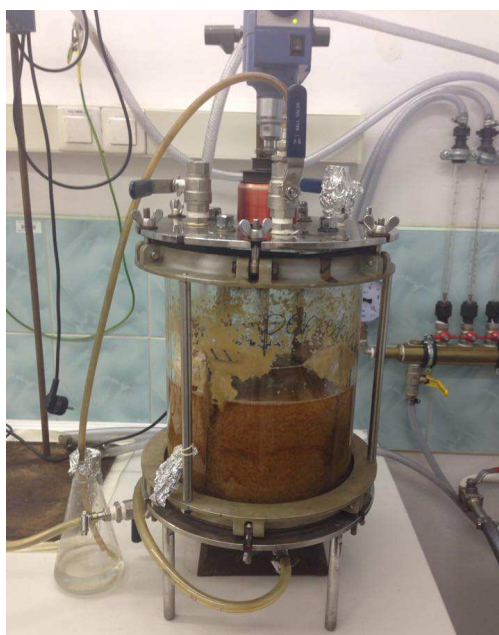
Ryc. 9. Bioreaktor firmy BioTec o pojemności całkowitej 8 l (pracownia biotechnologii farmaceutycznej Katedry i Zakładu Technologii Leków i Biotechnologii Farmaceutycznej)
