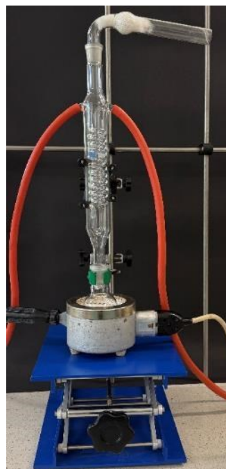
ZDJ. 68. ZESTAW DO OGRZEWANIA POD CHŁODNICĄ ZWROTNĄ Z ZABEZPIECZENIEM PRZED WILGOCIĄ
