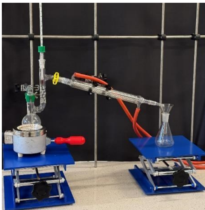
ZDJ. 70. ZESTAW DO OGRZEWANIA Z ODDESTYLOWANIEM PRODUKTU UBOCZNEGO (ACETANILID)
