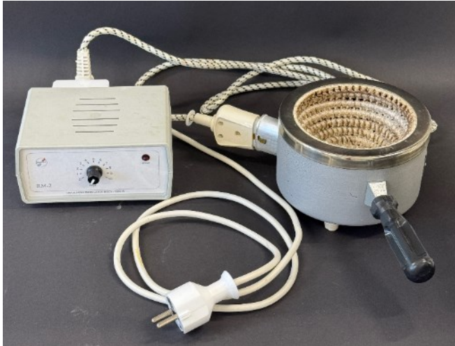
ZDJ. 39. CZASZA I AUTOTRANSFORMATOR
