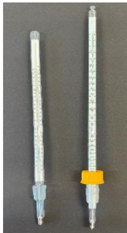
ZDJ. 21. TERMOMETR ZE SZLIFEM I TERMOMETR Z KRÓCCEM
