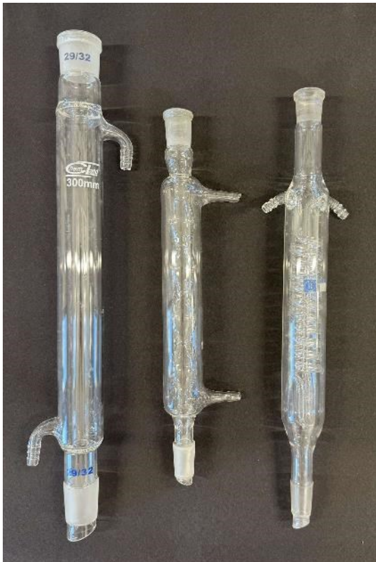
ZDJ. 13. CHŁODNICA LIEBIGA, KULKOWA I SPIRALNA Z EWNĘTRZNYM CHŁODZENIEM
