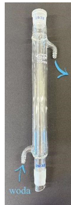
ZDJ. 12. CHŁODNICA ZWROTNA Z KIERUNKIEM PRZEPIYWU WODY
