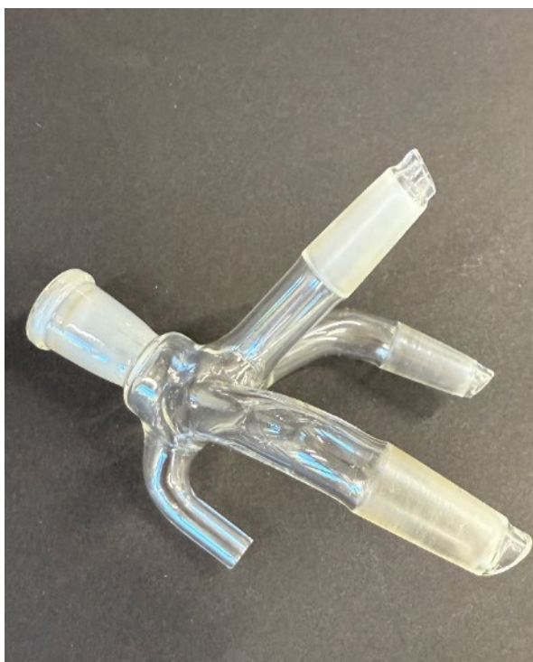
ZDJ. 24. NASADKA DO DESTYLACJI POD ZMNIEJSZONYM CIŚNIENIEM („KRÓWKA”)
