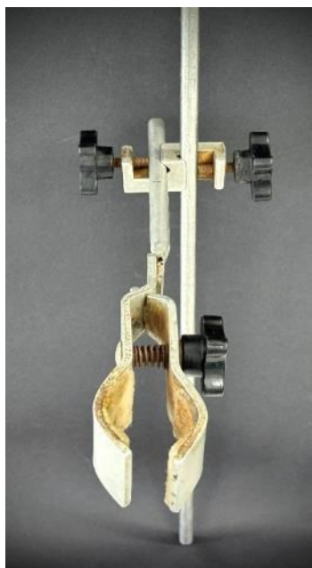
ZDJ.34A. ŁAPA ZAMONTOWANA PRAWIDŁOWO
