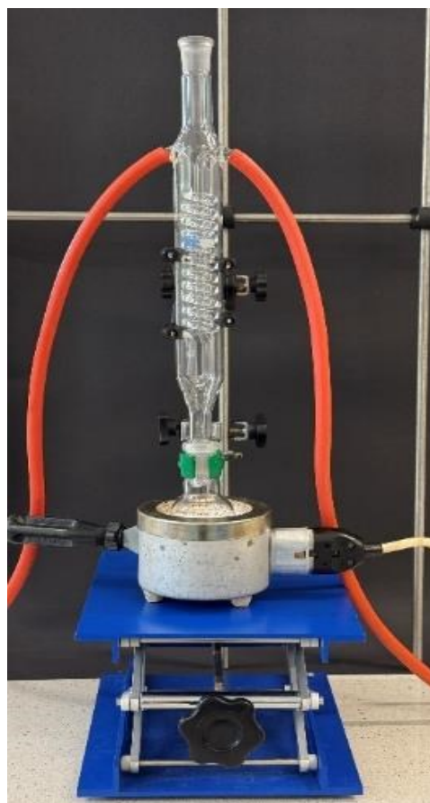
ZDJ. 74. APARATURA DO KRYSTALIZACJI – ROZPUSZCZALNIK PALNY
