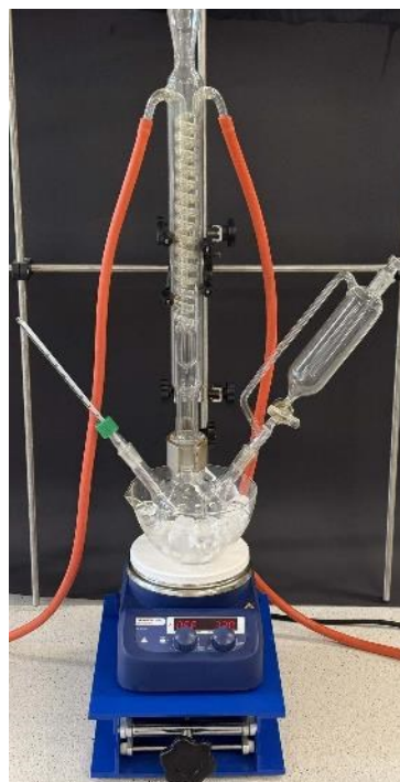
ZDJ. 72. ZESTAW Z MIESZADŁEM MAGNETYCZNYM/CHŁODZENIE/ WKRAPLACZ/ TERMOMETR
