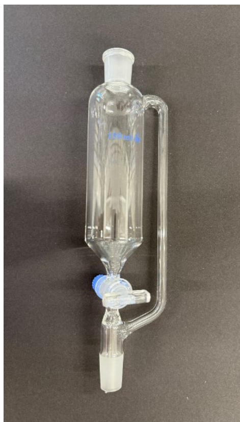
ZDJ. 15. WKRAPLACZ CYLINDRYCZNY Z WYRÓWNIANIEM CIŚNIEŃ
