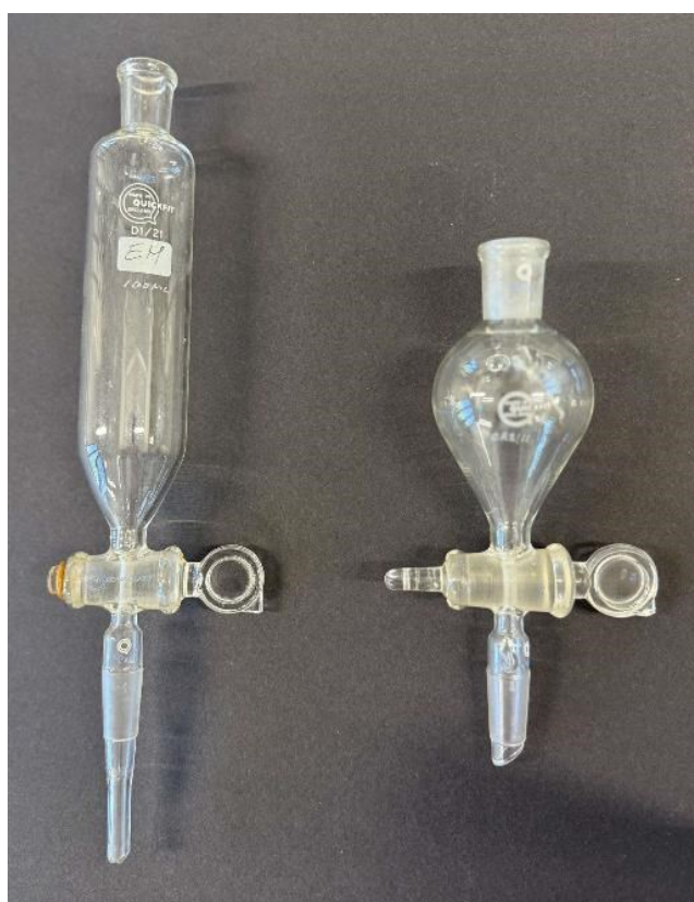
ZDJ. 16. WKRAPLACZ CYLINDRYCZNY I GRUSZKOWY BEZ WYRÓWNIANIA CIŚNIEŃ
