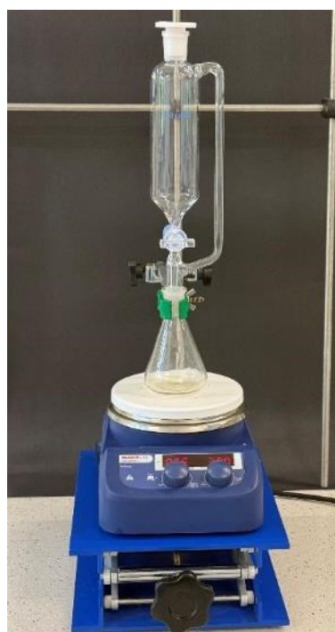
ZDJ. 73. ZESTAW Z MIESZADŁEM MAGNETYCZNYM I WKRAPALANIEM/ KOLBA STOŻKOWA
