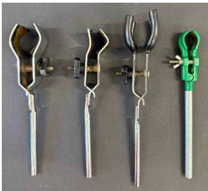
ZDJ. 31. (OD LEWEJ) ŁAPA OKRĄGŁA, TRÓJKĄTNA, CZTEROPALCZASTA, DO NACZYŃ O WĄSKIM PRZEKROJU
