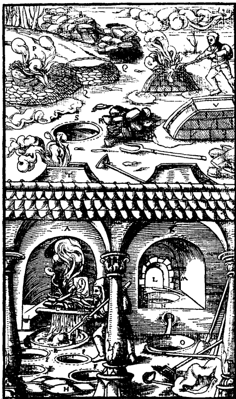
Fig. 31. Vier verschiedene Ausschmelzungsarten des Bleies aus seinen Erzen nach einem Holzschnitte vom Jahre 1557.
