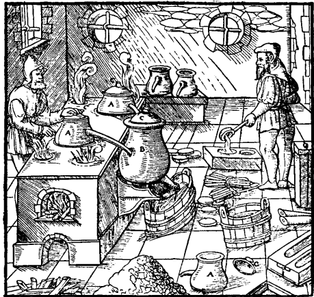
Fig. 45. Gewinnung von Schwefel durch Destillation nach einem Holzschnitte vom Jahre 1557.
