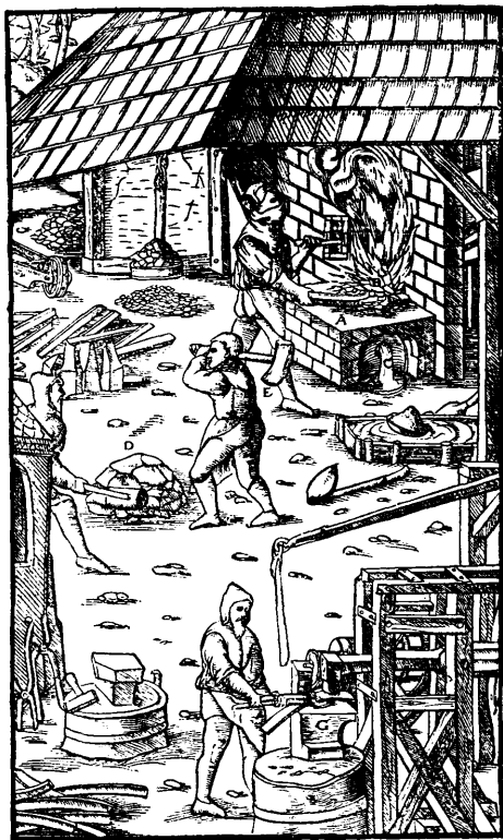
Fig. 36. Herd zur Aufschmelzung von Eisenerzen und Hammerwerk nach einem Holzschnitte vom Jahre 1557.
