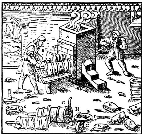
Fig. 54. Schmelzofen für Zinnerze nach einem Holzschnitte vom Jahre 1557.
