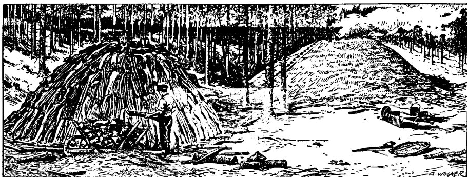
Aufgeschichteter und brennender Kohlenmeiler.
